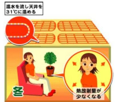
天井パネル内に毛細管マットを設置したものを通常の天井パネルのように配置、配管していく。
