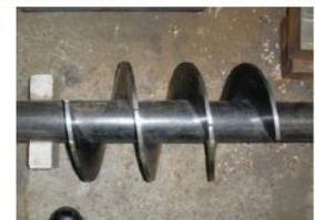
羽根曲げ成型機で製作したスクリー羽根
