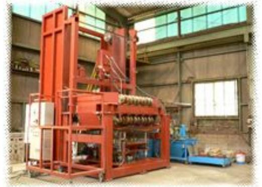
ワイヤースライサーマシン 石英ガラス最大切断寸法 2000mm×1600mm の大型機をはじめ、9台保有。
